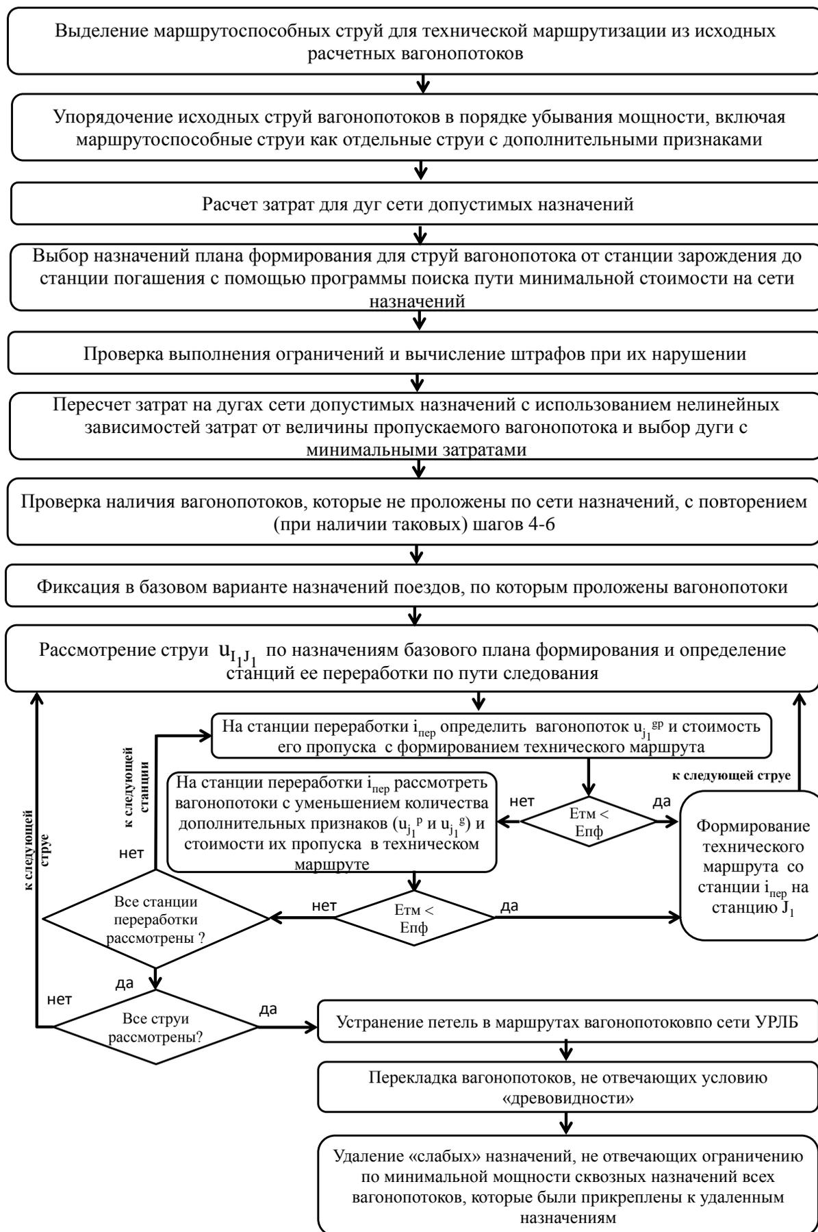
Рисунок 7 – Блок-схема второго варианта алгоритма выделения технических маршрутов
